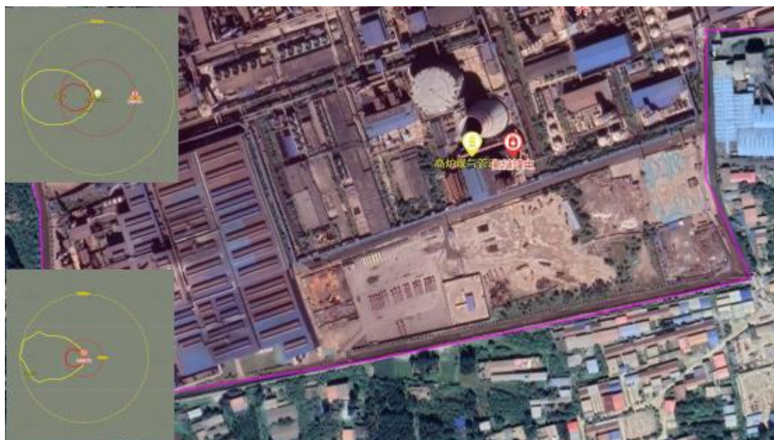
图 5.1-3 氨水、高炉煤气泄漏最不利气象条件最大终点浓度范围图
